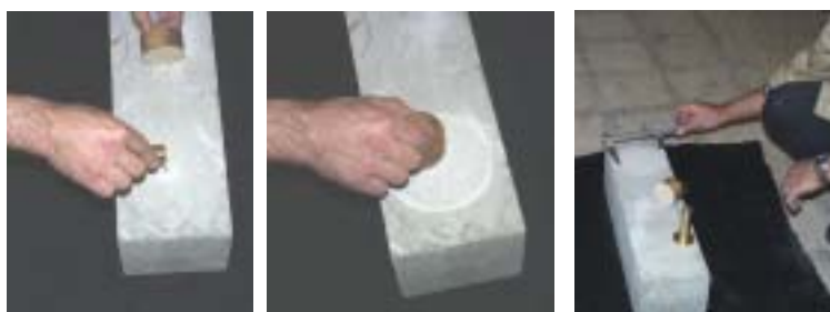
Figura 3: Determinação da rugosidade pelo método da “coluna de areia”
