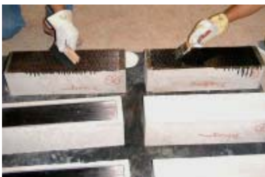
Figura 7: Passagem de espátula de borracha e aplicação da última camada de adesivo
