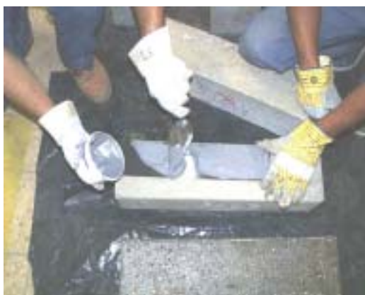
Figura 4: Aplicação do adesivo sobre o laminado
