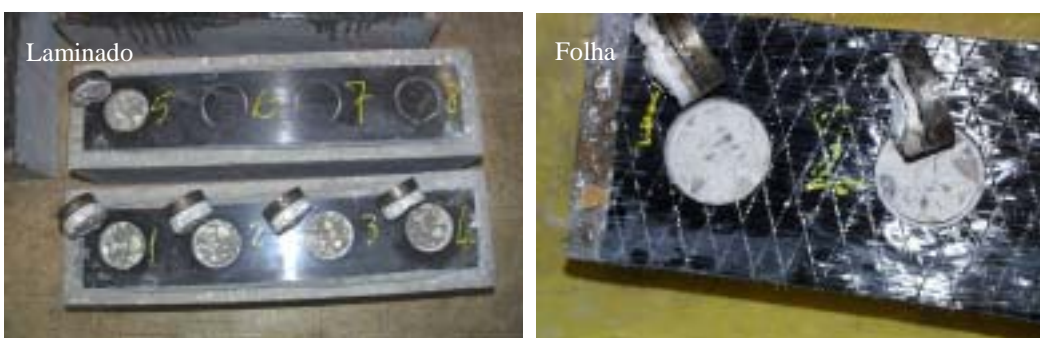
Figura 9: Tipologia da rotura obtida nos ensaios de aderência – rotura coesiva no seio do betão
