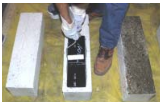
Figura 6: Passagem de rolo semi-rígido sobre o laminado
