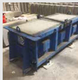
Moldes de bloco
