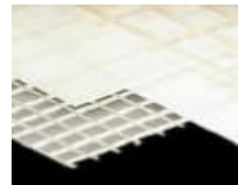
Combinação de geogrelha com um tecido de alta absorção
