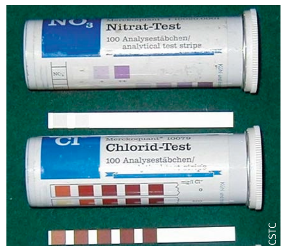
Fig. 41 Bandelettes indicatrices servant à déterminer la présence de sels (nitrates et chlorures).
