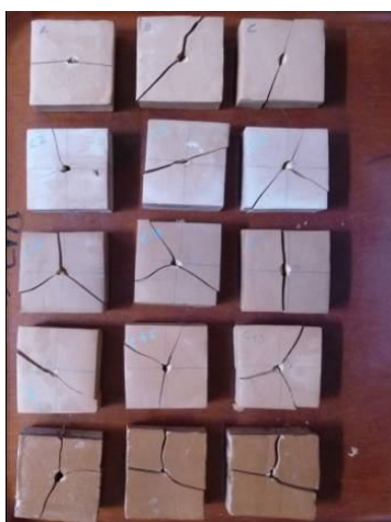
Fig. 3.15 – Aspecto geral dos provetes após o ensaio de resistência à compressão pontual onde se pode observar a tipologia de fracturas geradas.
