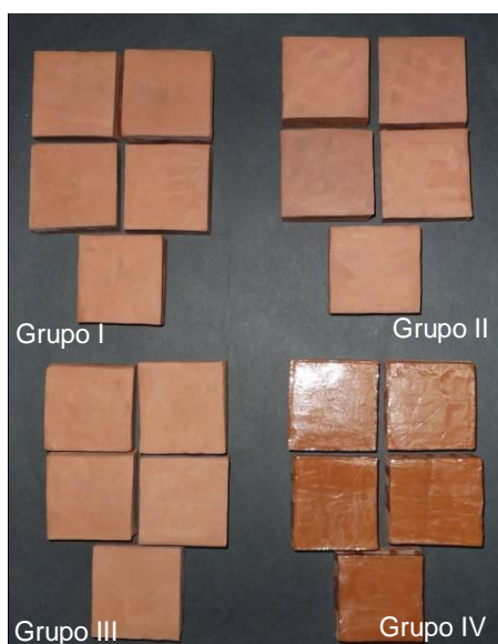
Fig. 2.3 – Aspecto geral dos 4 grupos de provetes consolidados : Grupo I-imersão total dos provetes em solução de silicato de etilo; Grupo II-imersão total dos provetes consolidados com Paraloid B-72; Grupo III-pincelagem de uma das faces dos provetes com solução de silicato de etilo; Grupo IV-pincelagem de uma das faces dos provetes com solução de Paraloid B-72.
