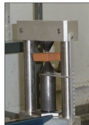
Fig. III.2 – Equipamento utilizado no ensaio de resistência à compressão pontual.
