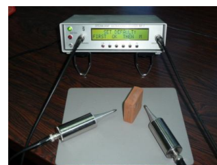
Fig. III.3 – Equipamento utilizado para a determinação da velocidade de propagação de ondas longitudinais.
