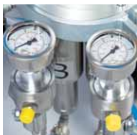
Unidade de medição de pressão na saída da máquina para os componentes A + B
