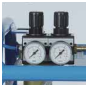
Manómetro com redutor de pressão para os componentes A + B e bomba de lavagem
