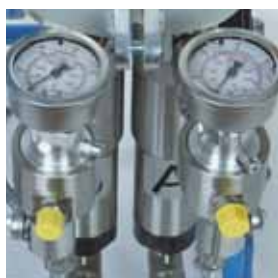
Unidade de medição de pressão na saída da máquina para o componentes A + B
