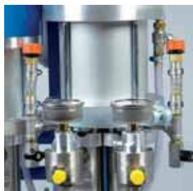
Lubrificações a óleo dos conjuntos de vedação
