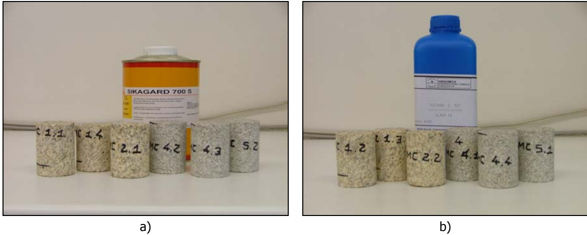
Figura 2.13 Aspecto dos provetes 24 horas após a aplicação dos dois produtos hidrófugos (2005/04/19): a) Após a aplicação do hidrófugo Sikagard 700 S; b) Após a aplicação do hidrófugo HB Siliker S 101.
