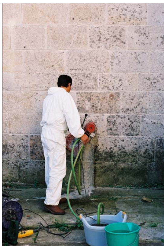
Figura 2.1 Extracção dos tarolos 1, 2 e 3 da fachada Norte na parede entre as capelas da Árvore de Jessé e a do Bom Jesus dos Mareantes (Setembro 2004).
