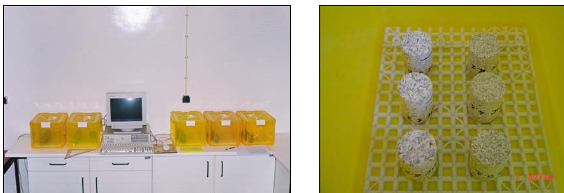
Figura 2.5 Equipamentos utilizados no ensaio de absorção de água por capilaridade e aspecto dos provetes durante o ensaio.
