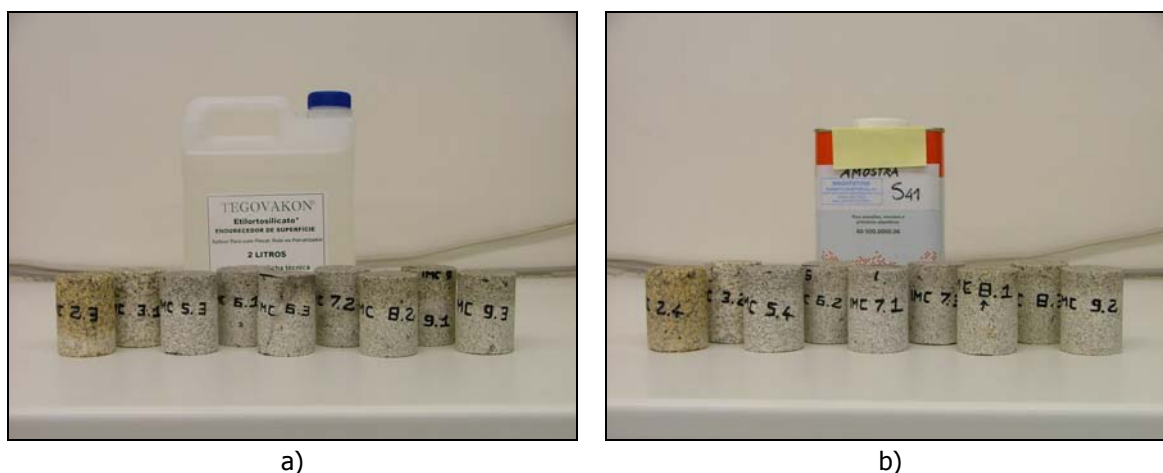
Figura 2.11 Aspecto dos provetes 24 horas após a aplicação dos dois produtos consolidantes (2005/04/19): a) Após a aplicação do consolidante Tegovakon V; b) Após a aplicação do consolidante HMK S 41.
