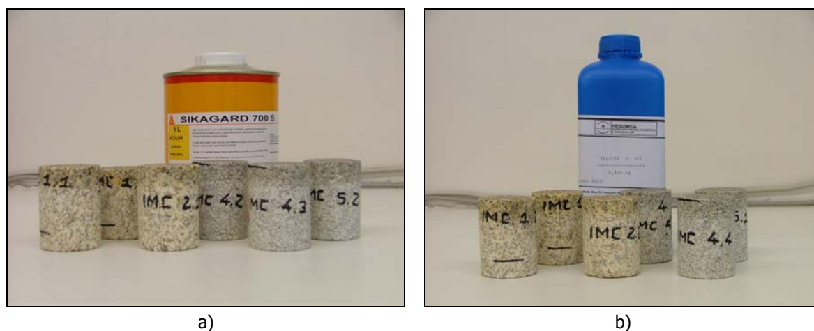
Figura 2.12 Aspecto dos provetes logo após a aplicação dos dois produtos hidrófugos (2005/04/18): a) Após a aplicação do hidrófugo Sikagard 700 S; b) Após a aplicação do hidrófugo HB Siliker S 101.
