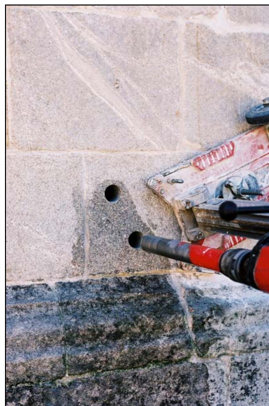
Figura 2.1 Extracção dos tarolos 1, 2 e 3 da fachada Norte na parede entre as capelas da Árvore de Jessé e a do Bom Jesus dos Mareantes (Setembro 2004).
