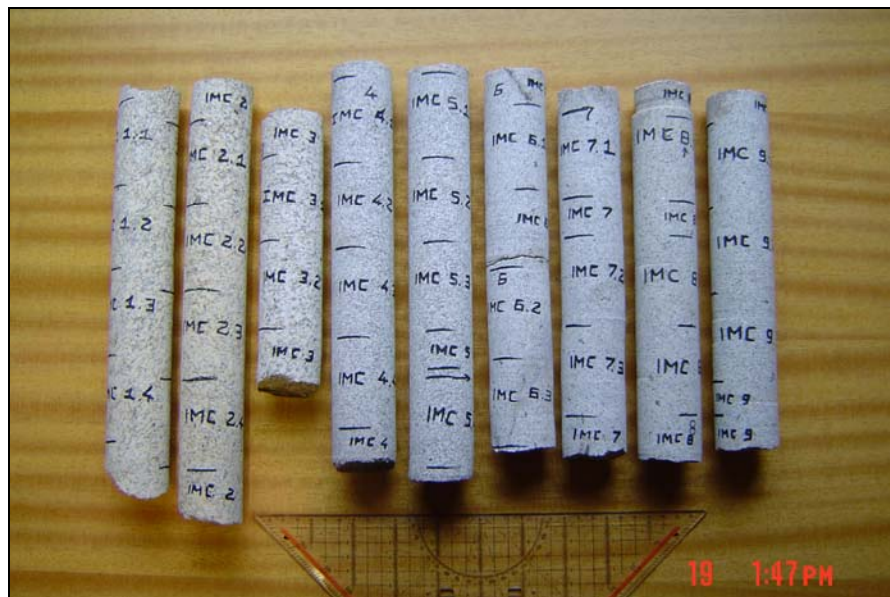
Figura 2.4 Tarolos retirados da fachada Norte e dos portais Oeste e Sul da Igreja Matriz de Caminha, já prontos para serem cortados de forma a formarem os respectivos provetes (Outubro de 2004).
