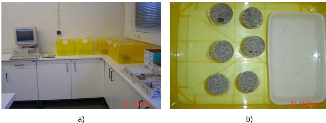
Figura 2.8 Ensaio de evaporação: a) Dispositivos utilizados na determinação do ensaio de evaporação; b) Aspecto dos provetes no início deste ensaio.
